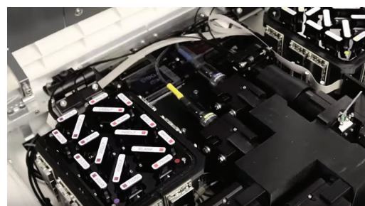
Изображение 16. Оптические фильтры проточного цитометра Attune NxT могут меняться самим пользователем, их легко установить и вынуть из оптического стола для расширения возможностей прибора.
